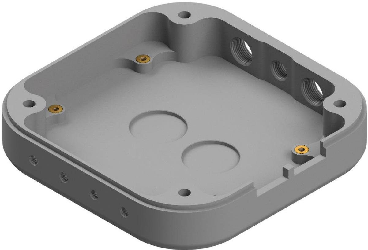
Einschweißmuttern in Gehäuse einschweißen. LötKolben mit breiter Spitze auf ca. 170° vorheizen. Mutter auf Bohrung setzen und mit leichtem Druck auf Position schieben.
