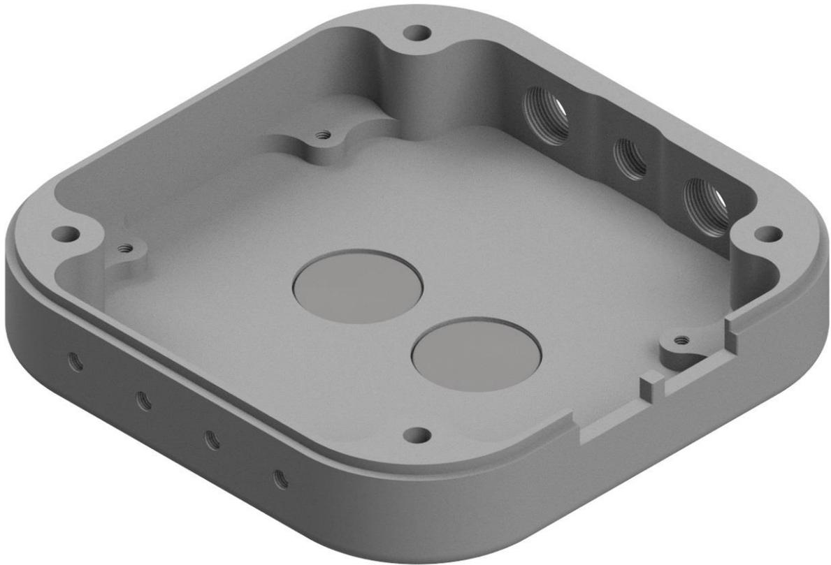
Magnete in Gehäuseboden einkleben.
