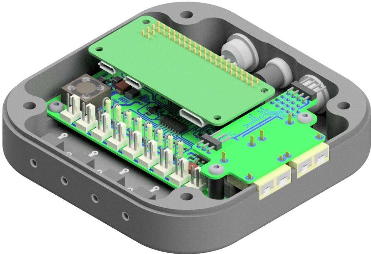
Micro-SD Karte in Raspberry Pi Zero stecken und den Raspberry Pi vorsichtig auf die Buchsenleiste der Mini V2 schieben.
