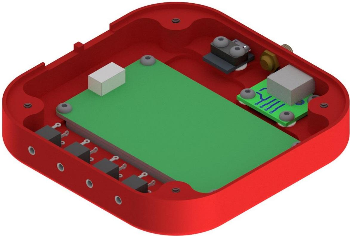
Display in Gehäusedeckel legen und mit vier M3x5mm Schrauben vorsichtig befestigen. Die Schrauben sollten gleichmäßig angezogen werden und es sollte dabei kein Druck auf das Display ausgeübt werden.
