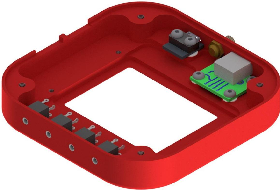
USB-A Breakout Board und USB Micro-B Breakout Board mit Kabel verlöten. Anschließend mit sechs Beilagscheiben M3, Brücke für USB Micro-B Breakout Board, zwei M3x8mm Schrauben und vier M3x5mm Schrauben befestigen.
